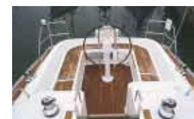
Poste de barre arrière.
