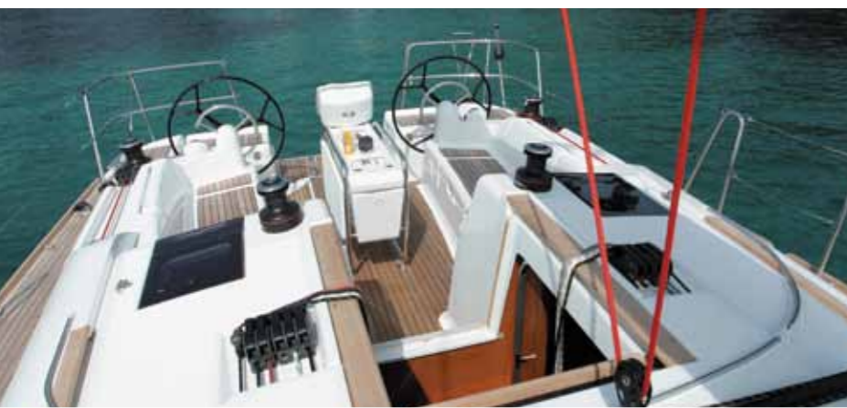
All sheets lead aft to the helm Centralisation des manœuvres à la barre Zentralisierung der Manöver am Ruder Centralización de las maniobras en el timón Manovre centralizzate al timone
